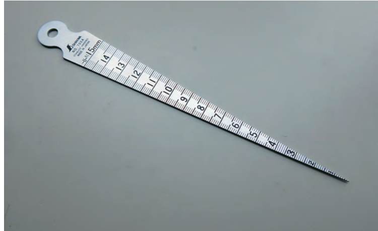
図2 内径の計測に使用したテーパゲージ
